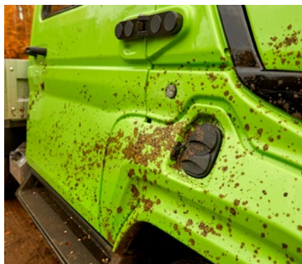
Bei gesteckten Schutzkappen: IP6K6K/IP6K9K
