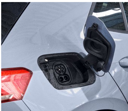
Bei offener Fahrzeug-Ladedose: IP6K6K/IP6K9K
